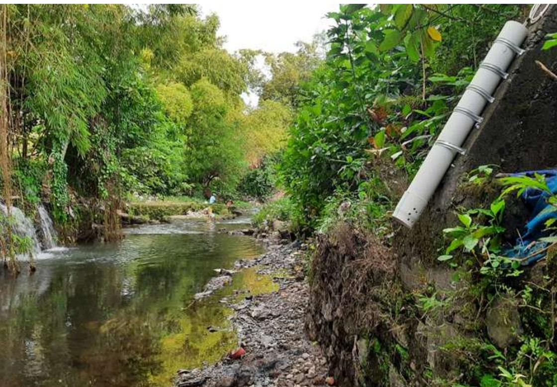
Gambar 34. Salah satu alat EWS yang telah terpasang. Foto: PB Palma GKJ Ambarrukma
